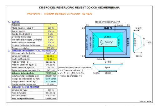
El cual al ser excavado con una pendiente de 1:1 necesitará de un recubrimiento para el mejor el aprovechamiento del agua y no contar con futuras perdidas por filtraciones. En este caso se proyecta el recubrimiento del reservorio con Geotextil de 250 gr para estabilizar las paredes y sobre el geotextil ira la geomembrana considerada para este caso: Geomembrana HDPE de 1.00 mm de espesor, la cual estará adherida al reservorio y asegurada con sus anclajes respectivos.
